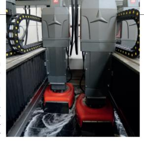
Le lucidatrici orbitali serie Orbital possono essere allestite in versioni dotate fino a un massimo di 22 teste con traslazione indipendente dei mandrini, ciascuno dei quali scorre su 4 guide Hiwin (due per il movimento orizzontale e due per quello verticale).
